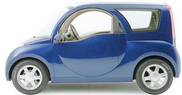
Bluecar - Bolloré - LMP(÷3vol÷5kg - 200km) 10 ans - rech 6 h - 20kE - 125 km/h - 2008
