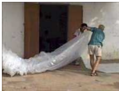
Photo 11. On place les deux pièces de plastique l'une dans l'autre
