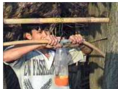
Photo 47. On insère le tube en PVC dans la bouteille, on remplit d'eau et on fait un petit trou pour fixer le niveau d'eau
