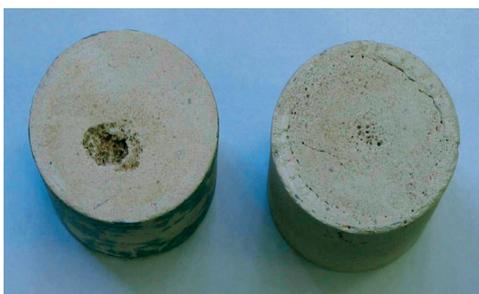
Résultat d'une injection de CO<sub>2</sub> sur une roche carbonatée
