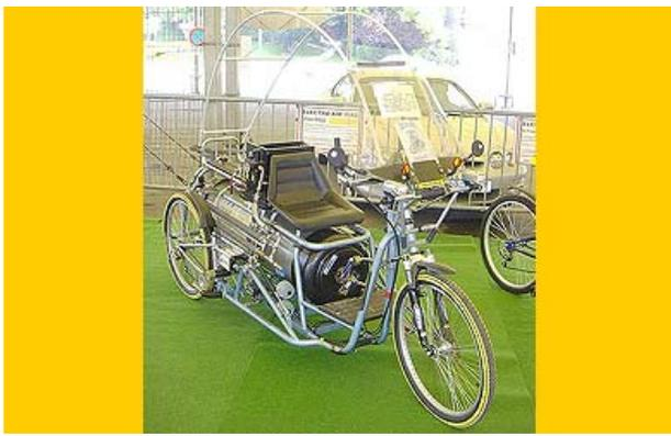
Rappelons au préalable qu'avec l'electrobike (à la structure on ne peut plus légère, photo ci-conte), assis sur une énorme bouteille de 126 litres de volume, pleine d'air comprimé à 200 bars, le conducteur a moins de 50 km d'autonomie.
