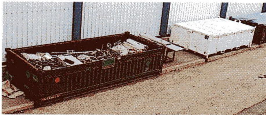
Bennes destinées à la collecte des déchets TFA, triés par nature (gravats, incinérables et divers)
