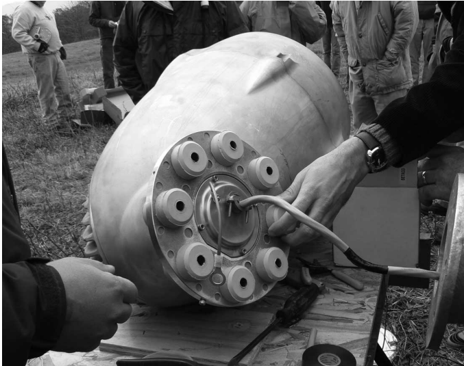
III. 4 Installer les isolateurs de vibration
