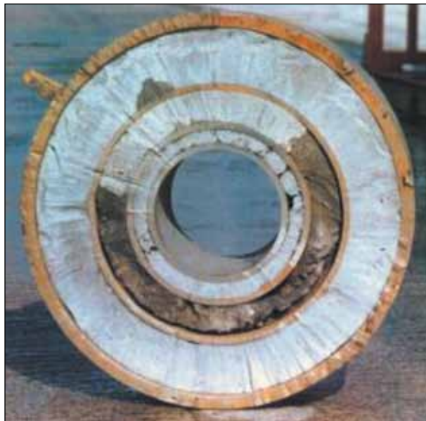
Section de la partie supérieure d'un forage : les 4 cuvelages séparés par 3 cimentations assurent son étanchéité
