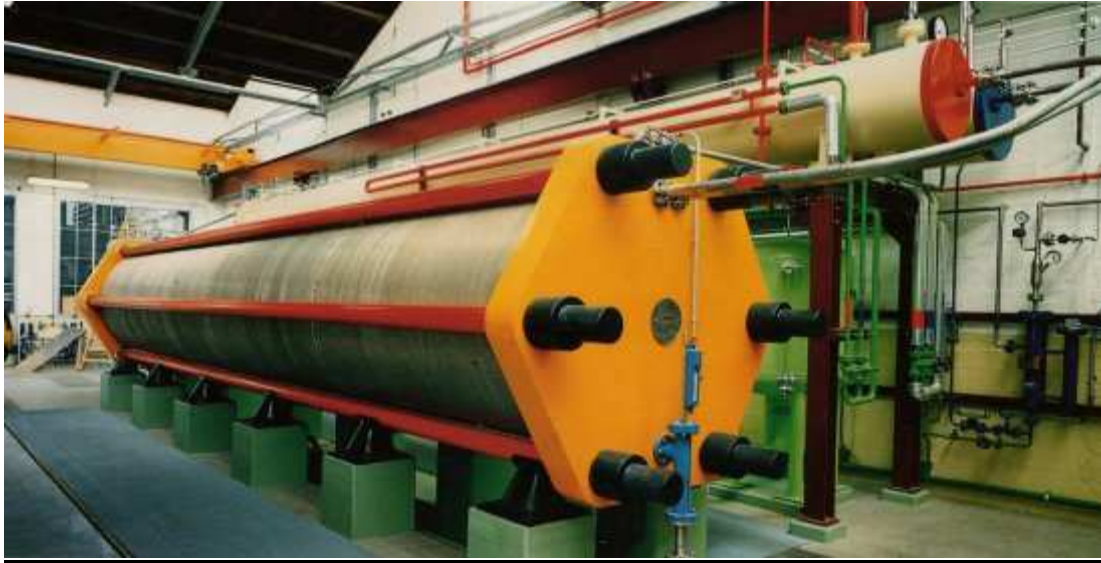
Electrolyseur alcalin ELT, 760 m 3 /h – 30 bars
