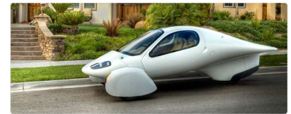
Figure 20.36. The Aptera. 6 kWh per 100 km .
