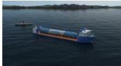
Le premier avantage de Flexblue® est d'être entièrement transportable par voie de mer vers son site de destination ou vers le chantier naval afin d'être rechargé en combustible ou entretenu. Sa fabrication en usine et sur chantier permet d'économiser les travaux de génie civil et de construire les unités en série, par berceaux modulables, en bénéficiant d'un gain de temps considérable et d'un niveau de qualité élevé et constant.
